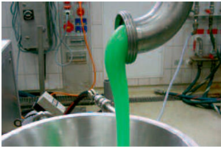
■ Lavt afslidning ved pumpning af tandpasta / Low abrasion conveyance of toothpaste
